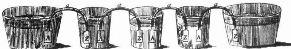
Рис.1.17. Установка Вольты для производства электричества
