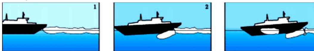
Рис. 5.17. Схема движения ледокола во льдах
